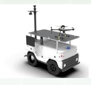
系統是為隧道檢測情況的不足和缺點而開發的。無需額外分配大量工作人員和工作平臺仍可自動採集隧道高清圖像,自動檢測隧道內 部表面結構的不同缺損,例如隔熱板、釉瓷內牆面板和行車道鋪設的混凝土裂紋及剝落等,全方位覆蓋檢測範圍。
